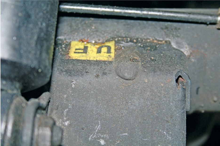
Hinterachse: Aufkleber links neben der Halterung für den Stoßdämpfer
